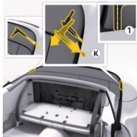
рис. 42: Уставлення ключа для аварійного розблокування
