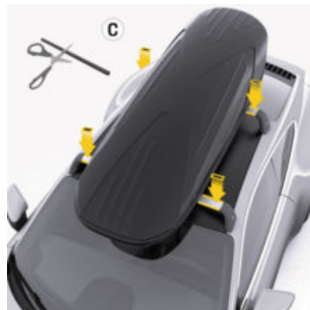
рис. 217: Підрізання та кріплення зовнішніх профілів
