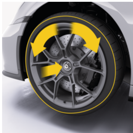
рис. 266: Як установити колесо на маточину
