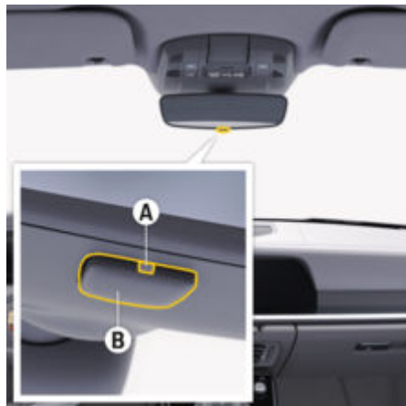
рис. 107: Автоматика затемнення внутрішнього дзеркала заднього виду
