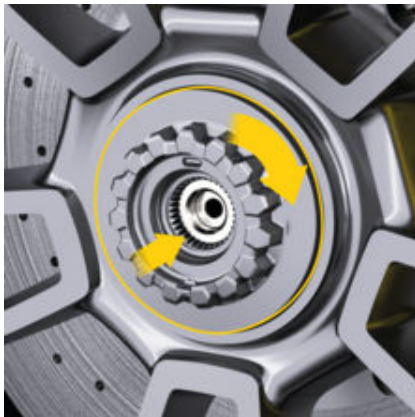
рис. 268: Як прикрутити центральний болт
