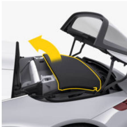
рис. 25: Закривання панелі даху
