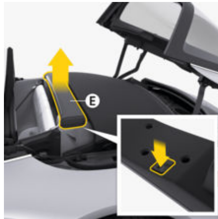
рис. 23: Демонтаж сонцезахисної шторки
