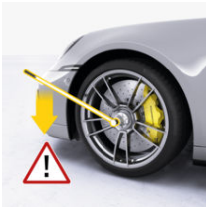
рис. 262: Вивертання центрального болта
