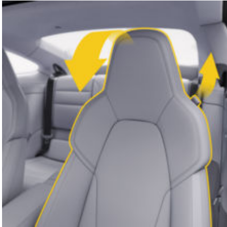
рис. 100: Складання спинки сидіння
