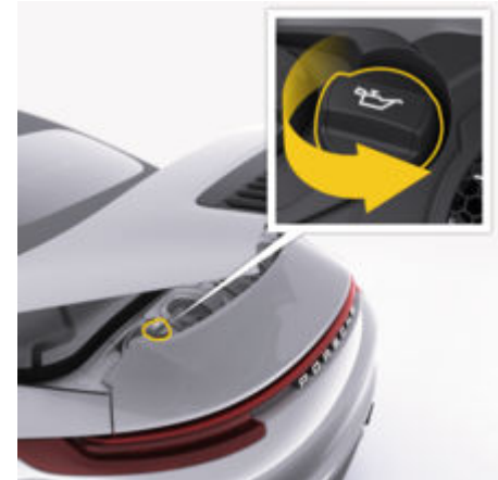
рис. 247: Відкриття кришки оливозаливної горловини в кабриолеті
