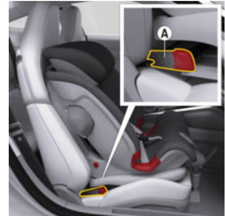
рис. 77: Установлення дитячої утримувальної системи з опорною стійкою
