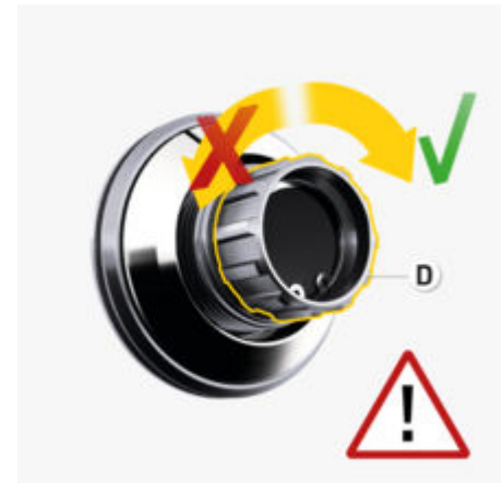
рис. 264: Перевірте механізм захисту від самовідгвинчування
