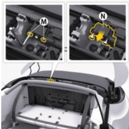
рис. 47: Ослаблення болтів і витягування вузла редуктора двигуна вперед
