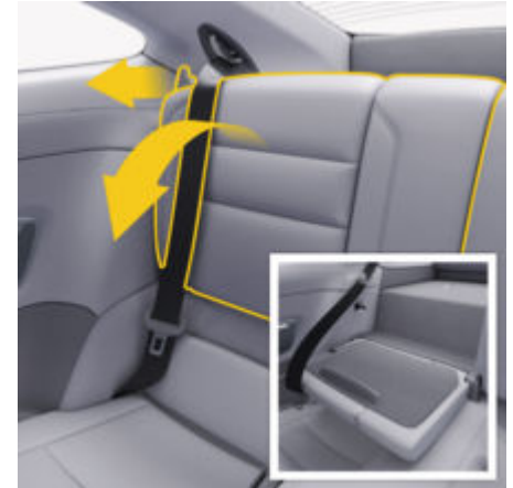
рис. 101: Складання спинки задніх сидінь
