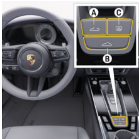
рис. 15: Управління системою скляного даху
