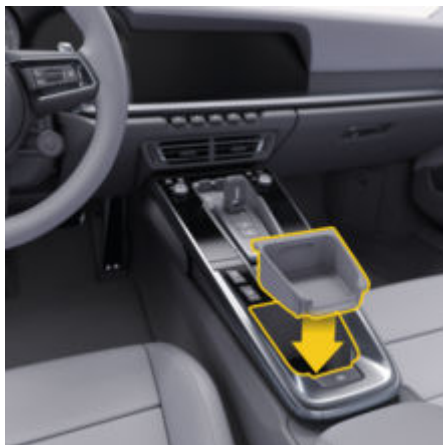
рис. 206: Уставляння й виймання відділення для дрібних речей
