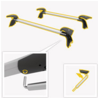
рис. 212: Ослаблення гвинтів із нижнього боку траверс
