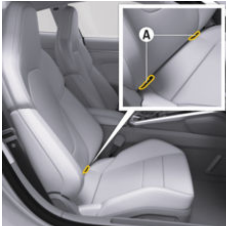
рис. 76: Кріплення ISOFIX на передньому пасажирському сидінні
