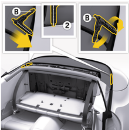
рис. 44: Розблокування кришки короба складаного верху (крок 2)
