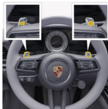
рис. 131: Кермо з пелюстками перемикання передач
