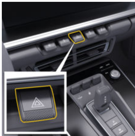
рис. 137: Увімкнення та вимкнення світлової аварійної сигналізації
