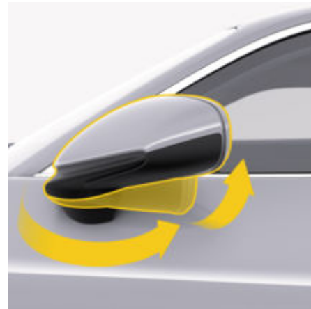
рис. 105: Складання й розкладання зовнiшнiх дзеркал заднього виду
