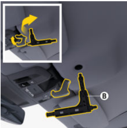
рис. 29: Закривання панелі даху
