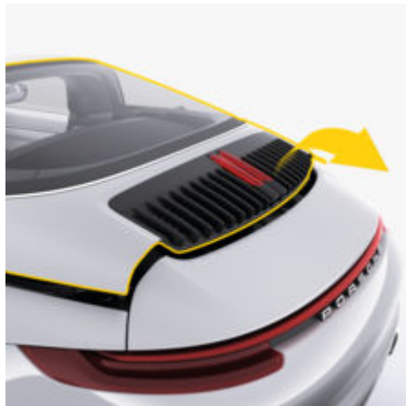
рис. 22: Відкривання скляної задньої кришки
