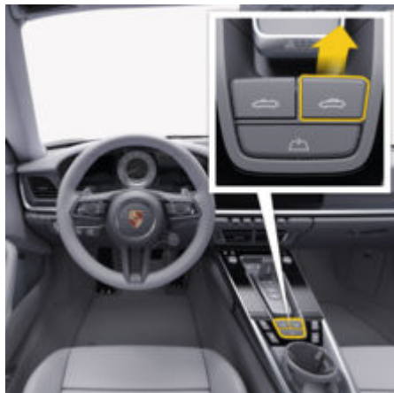
рис. 33: Закривання складаного верху за допомогою кнопки
