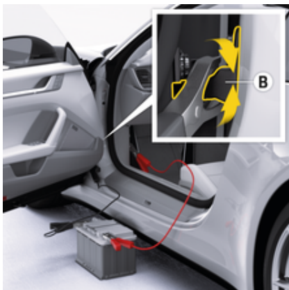
рис. 12: Аварійне розблокування капота – Під'єднання мінусової клеми
