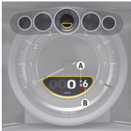
рис. 128: Індикатор режиму роботи й увімкненої передачі
