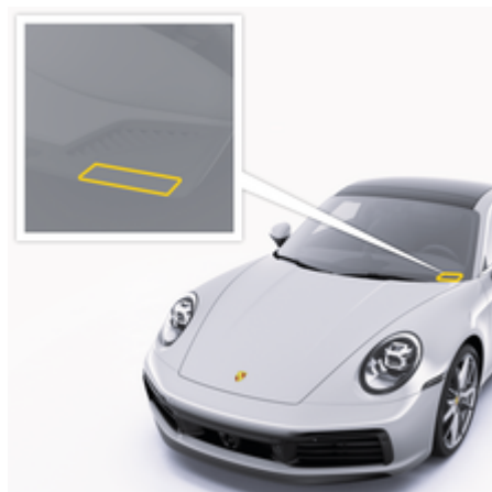
рис. 285: Розташування ідентифікаційного номера автомобіля
