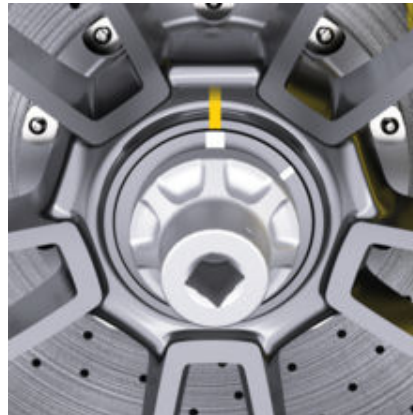
рис. 277: Як затягти центральний болт
