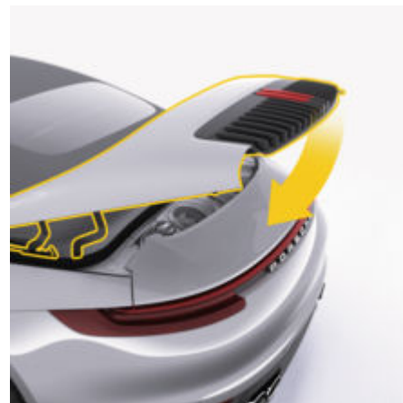
рис. 53: Закривання кришки короба складаного верху
