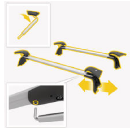
рис. 214: Затягування гвинтів із нижнього боку траверс
