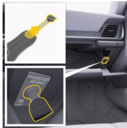
рис. 74: Вимкнення подушки безпеки переднього пасажир
