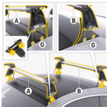
рис. 213: Регулювання довжини траверси
