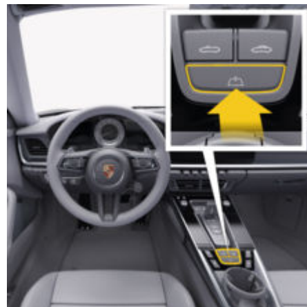
рис. 34: Розкладання та складання вітрозахисного екрана
