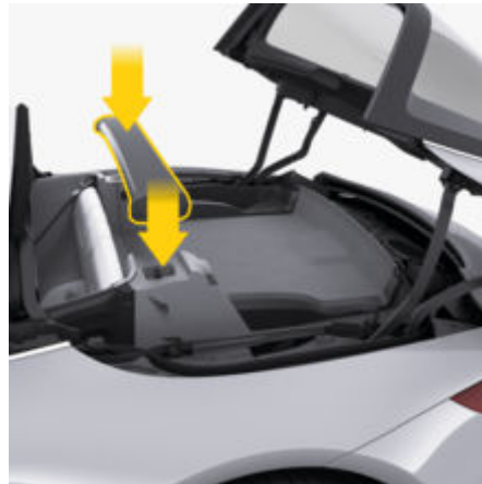
рис. 30: Монтаж сонцезахисної шторки
