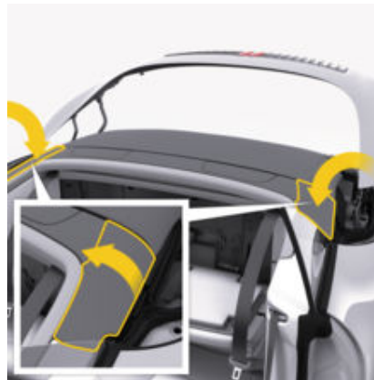
рис. 48: Притиснення кришок бічної обшивки задніх сидінь донизу
