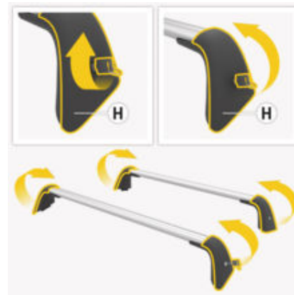
рис. 211: Розблокування та піднімання кришок
