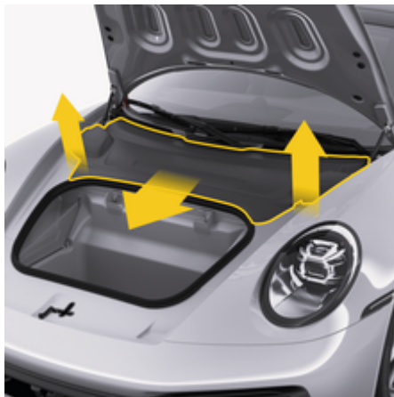
рис. 224: Розблокування й підняття пластикової кришки
