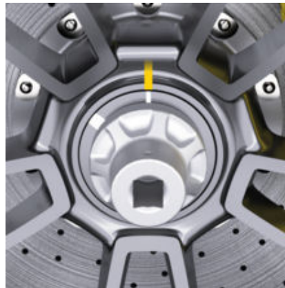
рис. 276: Маркування на центральному болті
