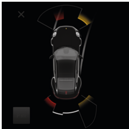
рис. 142: Дисплей системи ParkAssistent
