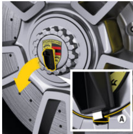
рис. 258: Відкриття кришки з використанням допоміжного інструмента
