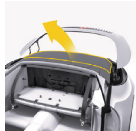
рис. 49: Виймання складаного верху з відсіку для зберігання
