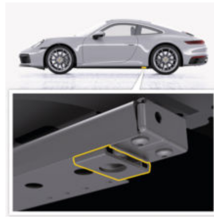
рис. 283: Точка опори для домкрата або підйомника ззаду
