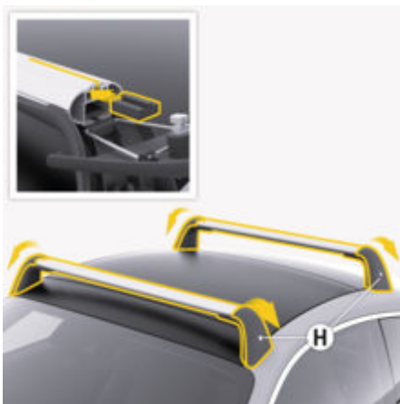
рис. 216: Установлення насадочних модулів
