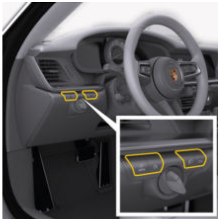
рис. 133: Панель керування освітлювальними приладами
