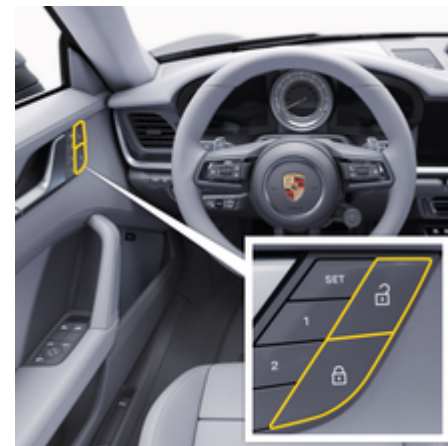
рис. 58: Кнопка центрального замка в обшивці дверей
