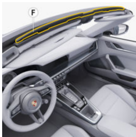
рис. 18: Висування та прибирання обтічника
