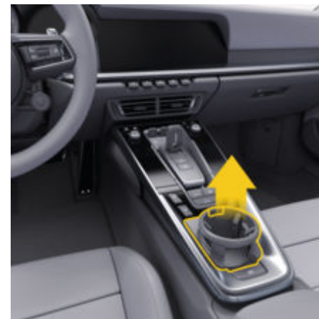
рис. 219: Виймання підсклянника з центральної консолі
