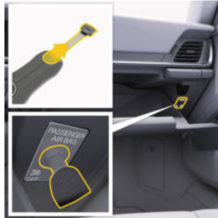
рис. 65: Вимкнення подушки безпеки переднього пасажира
